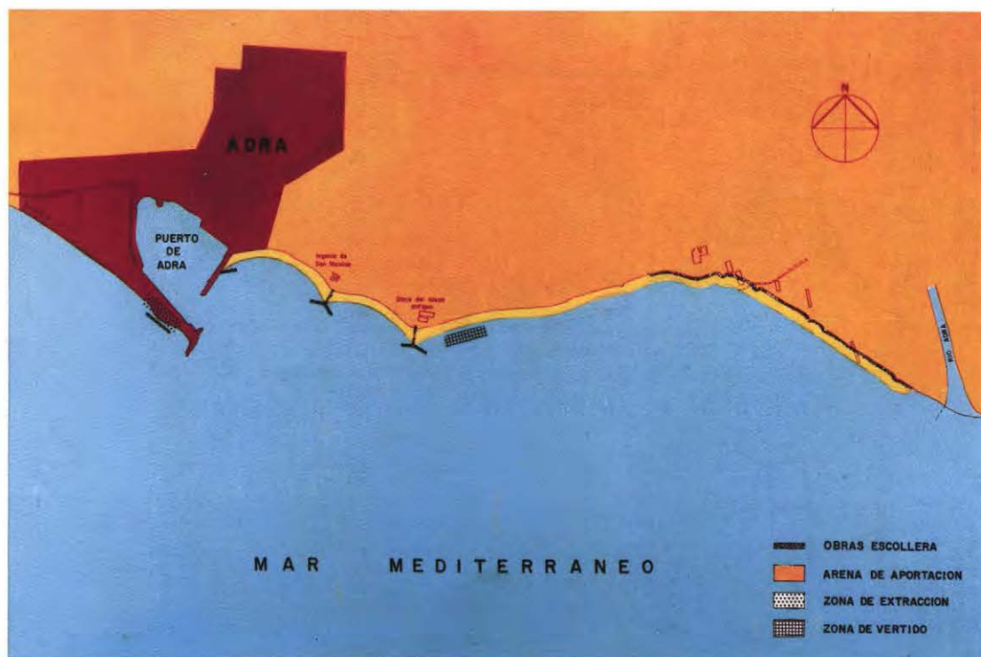
Puerto de Adra (Almería). Esquema de las obras realizadas para el trasvase de arenas del Puerto de Adra.
